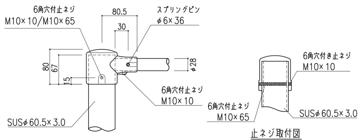
ステンレス铸件ジョイントA詳細図 1:5
