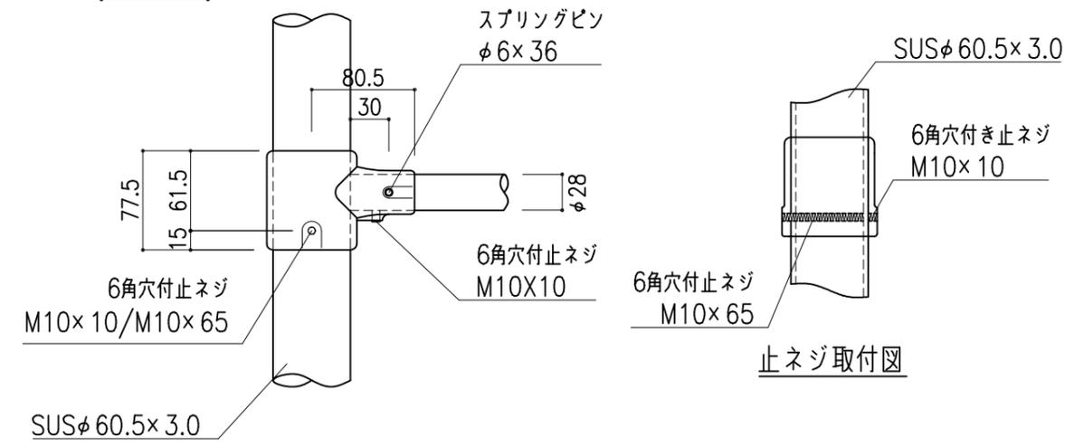
ステンレス铸件ジョイントC詳細図 1:5
